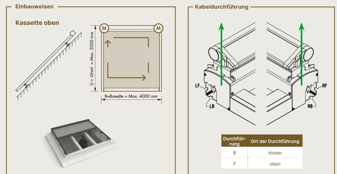
Betrachten Sie Ihren Topfix von der Position aus, an der Sie den Tuchsatz herausnehmen würden (→). Dies bestimmt die Auswahlmöglichkeit für eine Kabeldurchführung links oder rechts.
